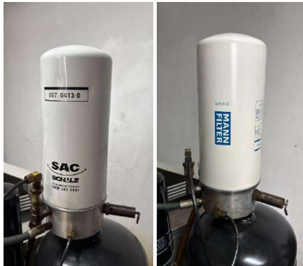
Substituição de filtro saturado (esquerda) para filtro novo (Direita)
